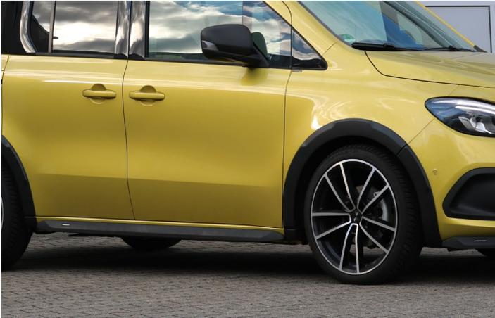
Der Seitenschweller müssen bündig, wie auf den Bildern links gezeigt, an der Karosserie anliegen.
