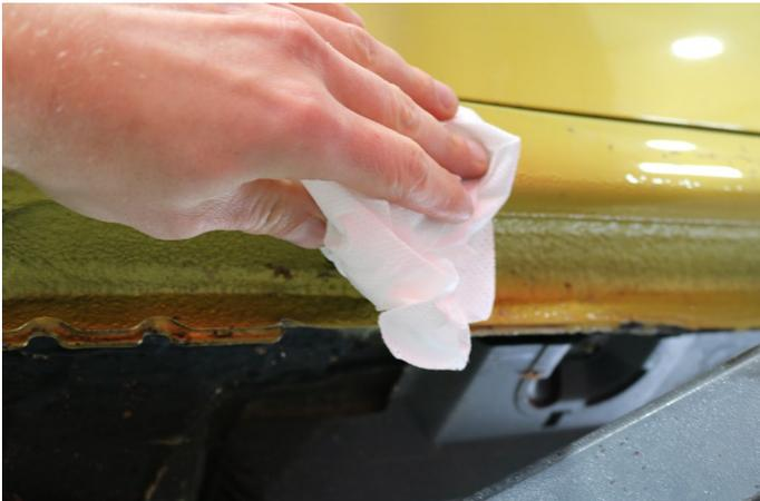
Reinigen Sie im nächsten Arbeitsschritt die Seitenschweller, sodass sich weder Sand noch Steine an den Verbindungsflächen befinden.
