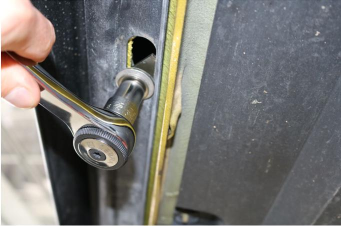
Setzen Sie den Seitenschweller an das Fahrzeug an und bringen Sie die vormontierte Exzenterschraube durch die Langlöcher in den Seitenschweller ein.
