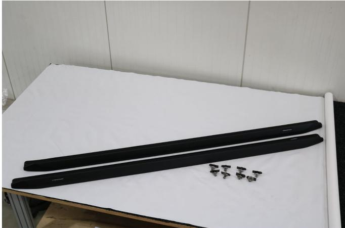
Das Bild zeigt die Seitenschwellerleisten mit den 8 Exzenterschrauben Frontspoilerlippe für den Citan der Baureihe 420.
