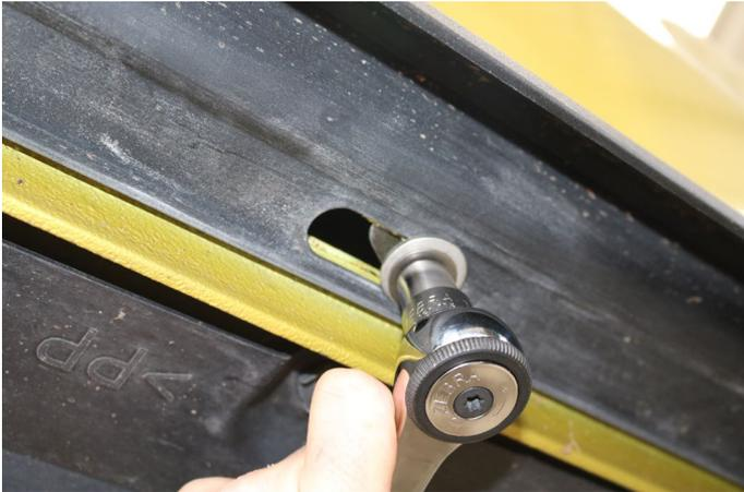
Wiederholen Sie diesen Vorgang an beiden Fahrzeugseiten, mit jeweils 4 Verschraubungen.
