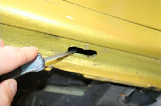
Entfernen Sie aus dem unteren Schwellerbereich die Gummistopfen.
