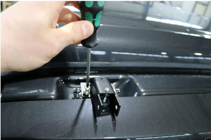
Verschrauben Sie im nächsten Arbeitsgang die beiden Halter für die Heckklappenscharniere mit den beiliegenden M8x25 Schrauben an den Heckklappenscharnieren mit einem **Anzugsmoment von 25 Nm**. Verwenden Sie pro Schraube einen Federring und eine Unterlegscheibe  $\varnothing$  8 mm.
