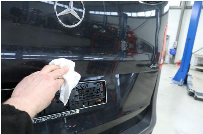
Reinigen Sie nun gründlich die Klebefläche der Abstützplatte. Verwenden Sie hierfür den im Lieferumfang enthaltenen Marston-Domssel Reiniger.
