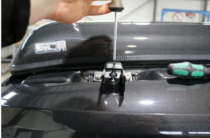
Drehen Sie Abstützschraube mit dem Kunststofffuß bis auf die Heckklappe hinunter, bis dieser „handfest“ aufsetzt.
