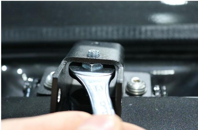
Drehen Sie anschließend die Kontermutter ebenfalls „handfest“ nach oben an, sodass die Stützschaube kein Spiel mehr hat.
