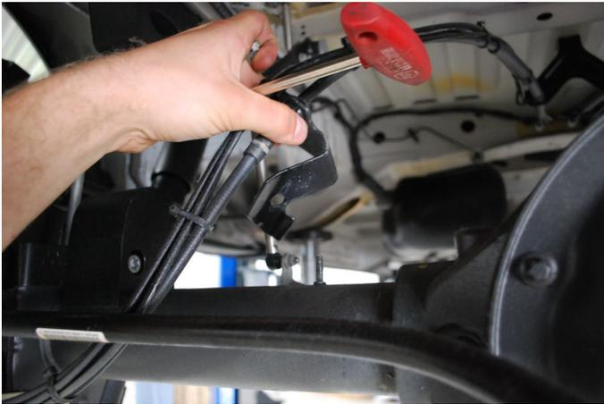
Beginnen Sie bei der Montage der Unterfahrschutzplatte des Hinterachsdifferentials mit dem Lösen des Halters für das Handbremsseil, auf der Achse, in Fahrtrichtung links.
