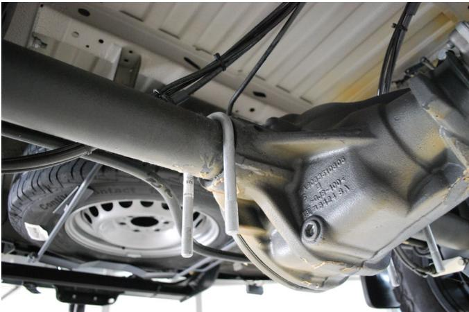
Legen Sie die Haltebügel links und rechts über den Achskörper.
