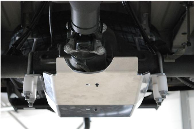
Das Bild links zeigt den montierten Unterfahrschutz für das Hinterachsdifferential.
