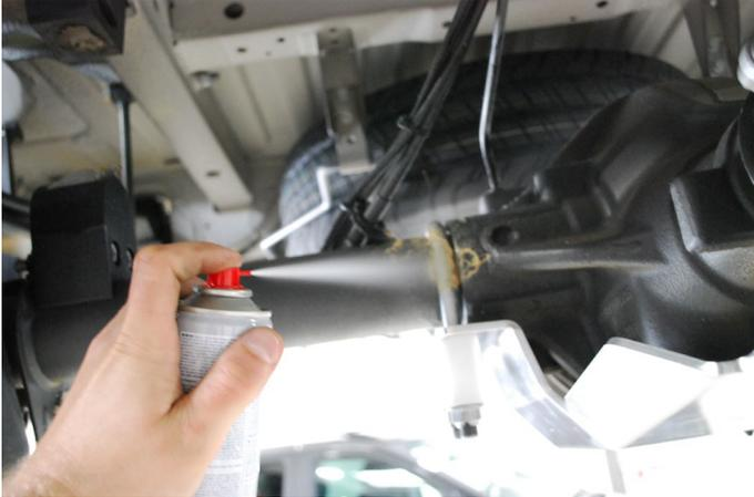
Zur besseren Haltbarkeit empfehlen wir, die Verschraubungspunkte sowie die Haltebügel mit Korrosionsschutz (Wachs) zu behandeln.
