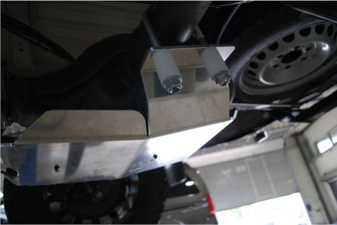
Montieren Sie die Unterfahrschutzplatte 907 61 302 mit den beiliegenden Kunststoffhülsen, und den M14 Muttern, wie im Bild links gezeigt.
