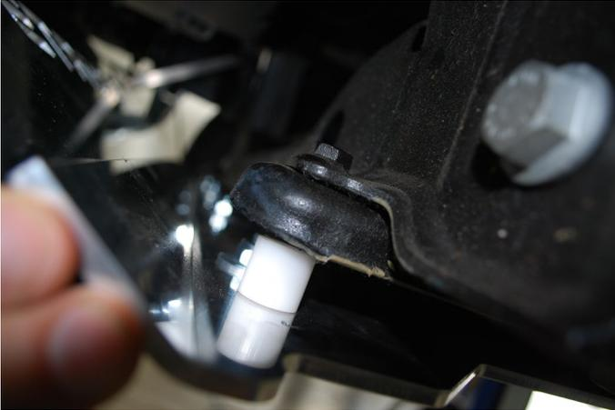
Verschrauben Sie die Unterfahrschutzplatte mit den beiliegenden Kunststoffhülsen, wie im Bild links gezeigt.
