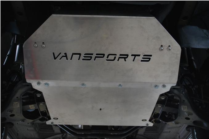
Fertig montierter Motor-Unterfahrschutz
