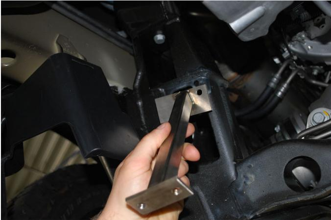
Im nächsten Arbeitsschritt montieren Sie die beiden Stützstreben für das Anfahr-Schutzschild (Teilenummer: Anfahrerschutzschild 907 61 3001) am Achsschemel links und rechts, wie im nebenstehenden Bild gezeigt.
