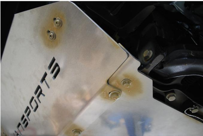
Zur besseren Haltbarkeit empfehlen wir, die Verschraubungspunkte mit Korrosionsschutz (Wachs) zu behandeln.
