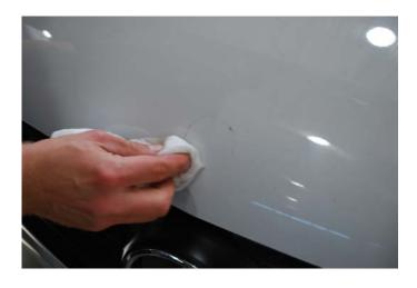
Reinigen Sie den Klebebereich gründlich mit dem beiliegenden Reiniger (MARSTON-DOMSEL MCL.D250)
