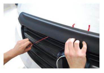
Setzen Sie das Aufsatzteil vorsichtig am Fahrzeug an. Ziehen Sie die roten Schutzfolien (4 Stück) nun jeweils nach außen hin weg.
