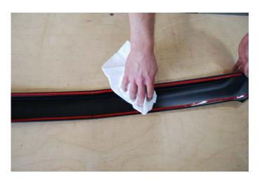
Reinigen Sie die Klebeflächen des Motorhaubenaufsatzes gründlich mit dem beiliegenden Reiniger (MARSTON-DOMSEL MCL.D250)
