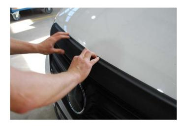
Drücken Sie nun das Aufsatzteil nun flächig an die Motorhaube an.
