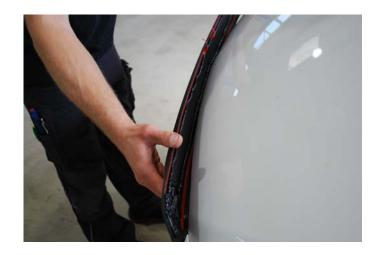
Setzen Sie den Motorhaubenaufsatz nun vorsichtig von unten an die Motorhaube an. Achten Sie darauf, dass die roten Klebeband-Schutzfolien jeweils 4-5 cm herausschauen.
