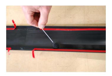
Im nächsten Arbeitsschritt primern Sie das Aufsatzteil an den Klebeflächen.
