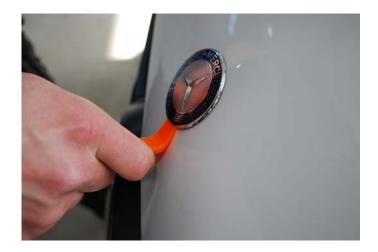
Entfernen Sie zunächst vorsichtig mit einem Kunststoffheber das Hersteller-Emblem auf der Motorhaube. Erwärmen Sie dieses zuvor ggfs. mit einem Heißluftfön.
