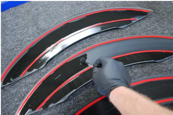
Im nächsten Arbeitsschritt primern Sie die Kotflügelau fsatzteile an den Klebeflächen.
