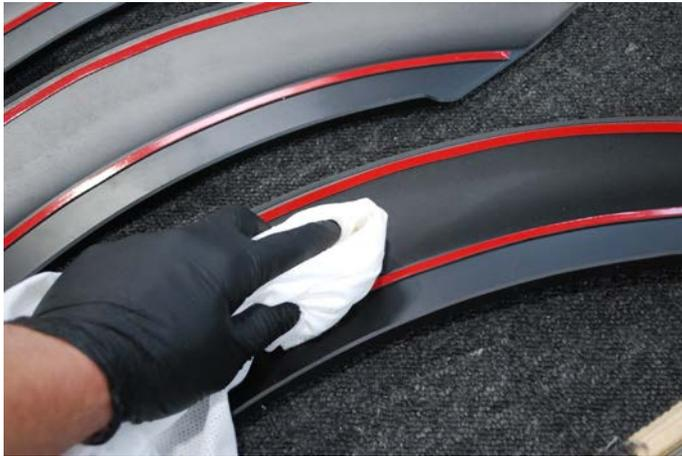
Reinigen Sie die Klebeflächen der Kotflügelaufsätze gründlich mit dem beiliegenden Reiniger (MARSTON-DOMSEL MCL.D250)
