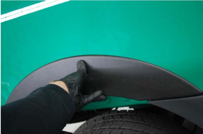
Drücken Sie nun das Kotflügelaufsatzteil flächig an der Karosserie an.
