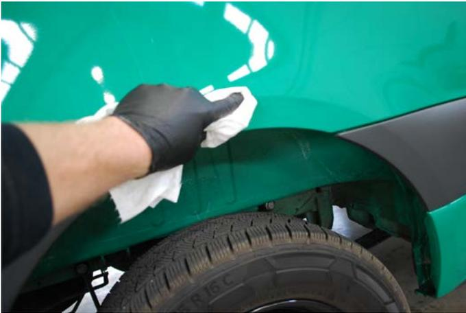
Reinigen Sie den Klebebereich gründlich mit dem beiliegenden Reiniger (MARSTON-DOMSEL MCL.D250)
