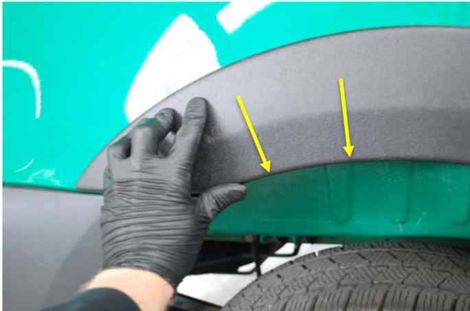
Setzen Sie das Kotflügelaufsatzteil vorsichtig am Fahrzeug an. Mit den Fingern spüren Sie den passenden Verlauf im Bereich der Kotflügelkante. Drücken sie das Aufsatzteil nur so fest an, dass das Kunststoffteil nicht über das Blechteil hinaus, in das Radhaus hinein ragt.
