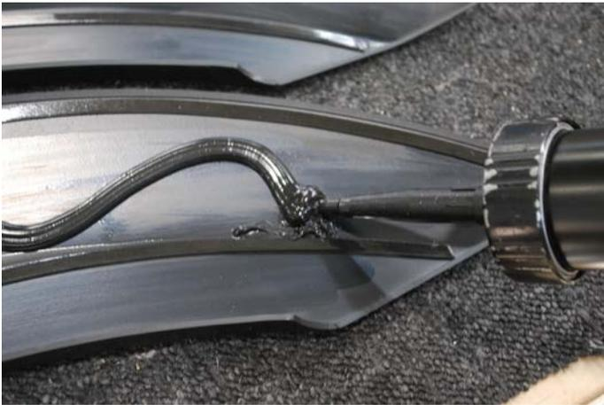
Bringen Sie nun zwei Wulsten des Marston Domsel Montageklebers ca. 5mm dick auf. Dieser Montagekleber ist für die dauerhafte Verklebung geeignet.
