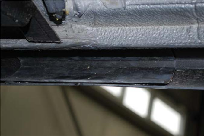
Bringen Sie auf die Enden links und rechts eine Klebewulst auf, und fügen Sie die Verbindungsstücke nun in den Seitenschweller ein. Achten Sie darauf, dass an den Fügespalten kein Kleber heraus quillt. Fixieren Sie die Enden mit einem geeigneten Werkzeug, z.B. mit Klammern.
