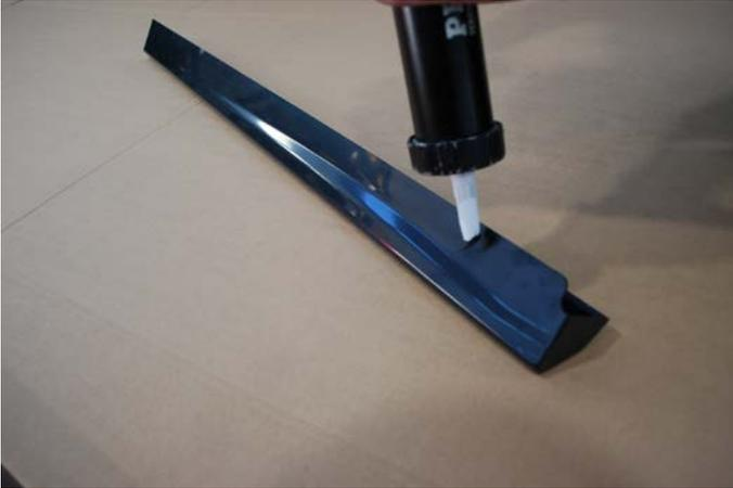
Bringen Sie eine dünne Wulst des mitgelieferten Montageklebers, über die gesamte Breite des Seitenschweller-Teilstücks auf. Beginnen Sie jeweils mit dem vorderen Teilstück des Seitenschwellers.
