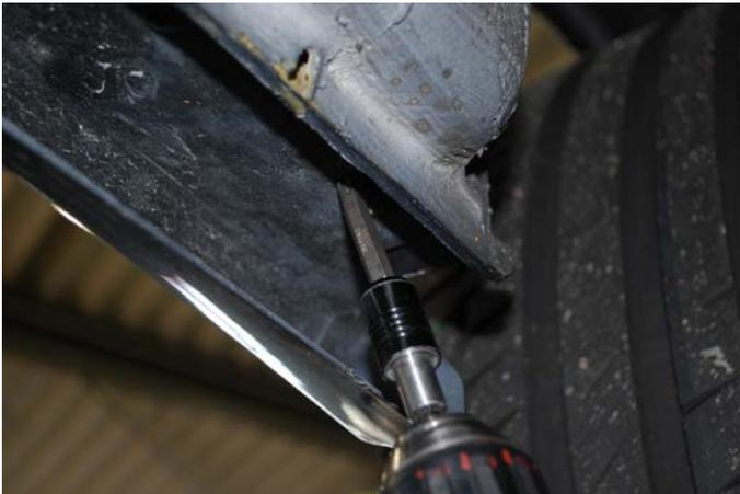
Fixieren Sie den SP Stream Seitenschweller mit den mitgelieferten Schneidschrauben im original Mercedes-Benz Schweller.
