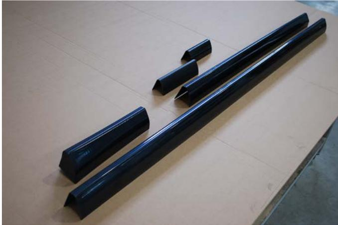
Legen Sie zunächst die Seitenschweller-Anbauteile auf einen Arbeitstisch. Machen Sie sich mit der Anbaulage der Teile am Fahrzeug vertraut. Kontrollieren Sie vor der Lackierung die Seitenschwellerteile auf etwaige Beschädigungen oder fertigungstechnische Rückstände. Bearbeiten Sie diese ggfs. nach. Lassen Sie die Seitenschwellerteile im Anschluss daran im gewünschten Farbton lackieren.
