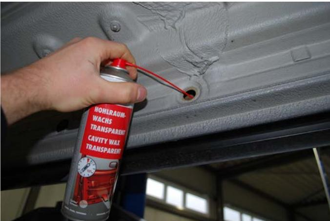
Nachdem Sie alle Verschraubungen des Seitenschwellers vorgenommen haben, öffnen Sie im letzten Arbeitsgang die Revisionsöffnungen (Gummipfropfen) des Mercedes-Benz Seitenschwellers, nahe den Verschraubungspunkten.
