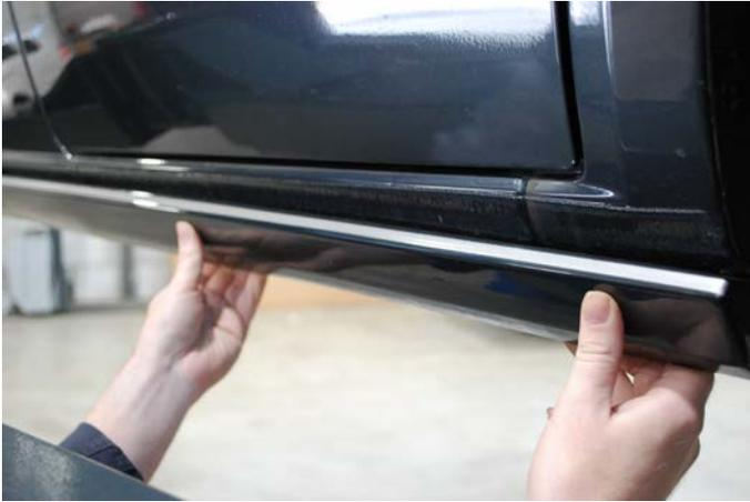
Nutzen Sie die letzte Möglichkeit zur Korrektur. Vergewissern Sie sich, dass alle drei Teilstücke des Seitenschweller, optisch eine durchgehende Linie bilden.
