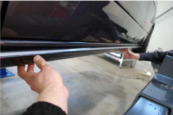
Setzen Sie zuerst das vordere Teilstück des Seitenschwellers am Fahrzeug an und richten dieses aus. Der vordere Radlauf dient Ihnen als Orientierungspunkt. Fixieren Sie das Teilstück mit einer Schneidschraube.
