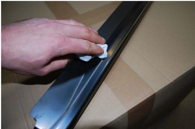
Entfetten bzw. reinigen Sie die lackierten (!) Klebeflächen mit dem mitgelieferten Reiniger.
