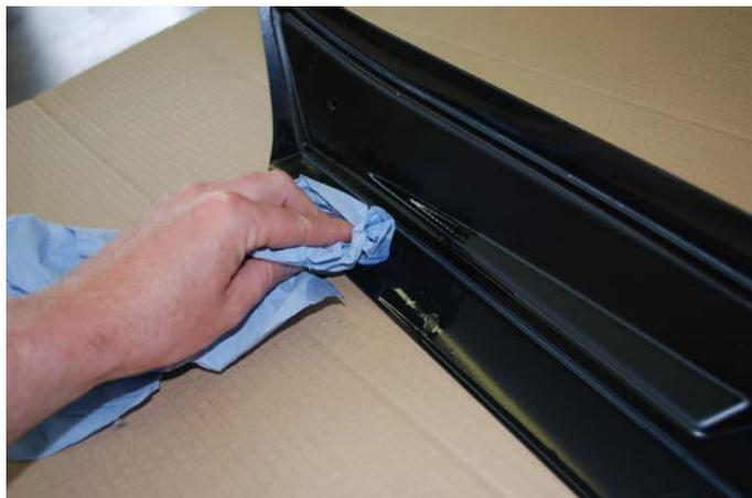
Reinigen Sie nun die Klebeflächen im Dachspoiler mit geeignetem, nichtfettenden Reiniger, wie z.B. Alkohol oder Bremsenreiniger. Verwenden Sie kein Aceton etc. . Diese Reiniger sind zu aggressiv und lösen die Oberfläche des ABS Materials zu stark an.
