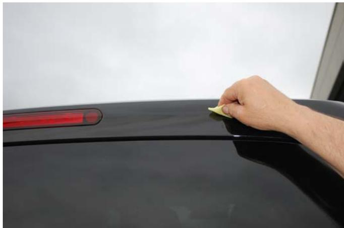
Primern Sie nach der Reinigung sorgsam die Klebeflächen, an denen der Dachspoiler verklebt wird.
