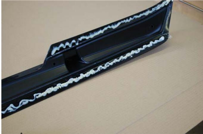
Im Bild noch einmal: Die Klebeflächen mit dem Montagekleber.
