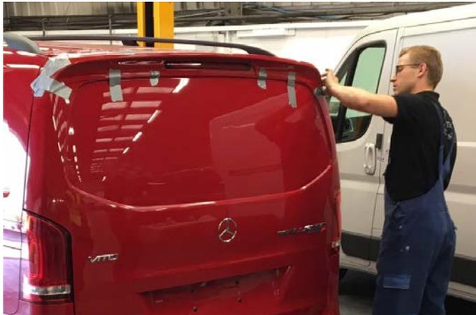
Pressen Sie den Dachspoiler mit den Klebeflächen fest an das Fahrzeug an. Fixieren Sie den Dachspoiler umgehend bis zur Aushärtung des Montageklebers mit reissfestem Klebeband am Fahrzeug.
