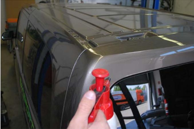
Reinigen Sie zunächst überaus gründlich die Klebeflächen an denen der Dachspoiler verklebt wird.
