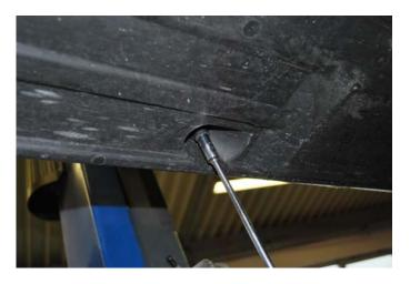
Lösen Sie zunächst die seitlichen unteren Verschraubungen der Blue Efficiency Unterbodenabdeckung, sowie die hinteren seitlichwaagerecht sitzenden Muttern und legen diese beiseite.\* (<u>Demontieren Sie bitte nicht die Unterbodenabdeckung!</u>)
