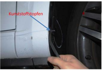
Lösen Sie den Kunststoffstopfen im vorderen Radhaus, ziehen Sie diesen komplett heraus und bewahren ihn auf. Lösen Sie vorn unten die Torxschraube und bewahren Sie auch diese auf.
