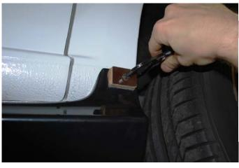
Fixieren Sie die Klebefläche des (lackierten) Seitenschwellers bis zur endgültigen Aushärtung mit einer Klemmzange.
