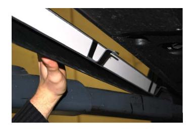
Setzen Sie den Seitenschweller an das Fahrzeug an, ziehen Sie (Bild unten) den Innenkotflügel des vorderen Radlaufs leicht von der Karosserie ab und schieben Sie das Vorderteil des Seitenschwellers zwischen Karosserie und Innenkotflügel.
