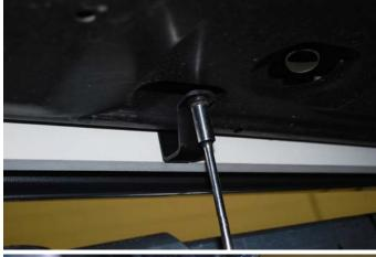
Verschrauben Sie den Seitenschweller von unten, (zunächst provisorisch) neuen Muttern.
