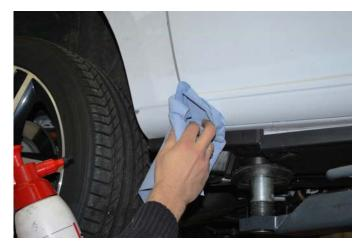
Bevor Sie den lackierten Seitenschweller nun endgültig verbauen, reinigen Sie die Klebeflächen mit einem nichtfettenden Reiniger.
