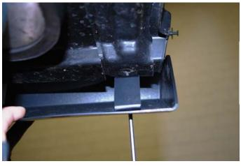
Im vorderen Bereich befestigen Sie den Seitenschweller ebenfalls an der Originalverschaubung für die Unterbodenabdeckung.
