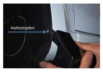
Sobald der Seitenschweller exakt sitzt, können Sie den Haltestopfen durch Innenkotflügel und Seitenschweller hindurch einbringen.
