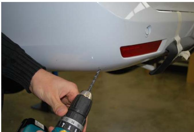
Entfernen Sie die Heckecken wieder, nachdem Sie die Bohrpunkte markiert haben. Bohren Sie an den angezeichneten Punkten die Verschraubungslöcher im Durchmesser 6 mm.
