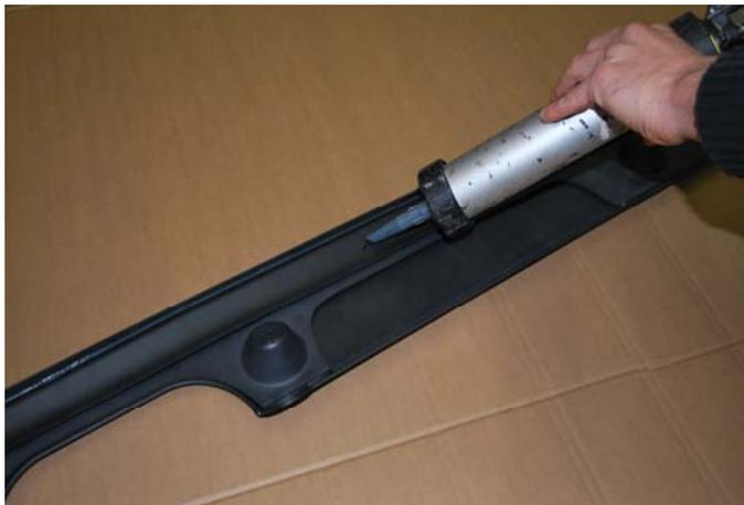
Bringen Sie den Klebstoff auf die komplette Klebefläche auf und setzen Sie erst dann das Heckmittelteil an die bekannte Stelle an. Verschrauben Sie das Bauteil an den zuvor eingebrachten Bohrungen Und fixieren Sie das Teil bis zur Aushärtung des Klebers noch einmal mit Klebeband.
