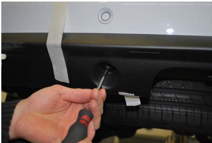
Nachdem die Heckecken fixiert sind, richten Sie das Heckmittelteil anhand der zuvor angebrachten Markierungen exakt aus und verschrauben Sie dieses nun (zunächst provisorisch) mit der Mercedes-Benz Heckschürze.
