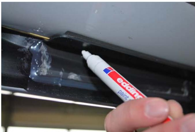
Markieren Sie mit einem Filzstift die Bohrpunkte (Diese sind in den Anbauteilen bereits vorhanden) von innen, bzw. von unten, an der Heckschürze.
