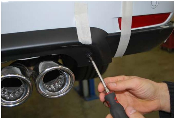
Die Heckecken und auch das Heckmittelteil sind nun provisorisch am Fahrzeug angebracht . Verschrauben Sie nun die Heckecken mit dem Heckmittelteil.
