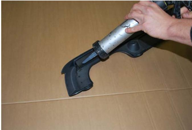
Nachdem die Heckecken fest am Fahrzeug montiert sind (geklebt und mit den Innenflächen verschraubt), montieren Sie nun das Heckmittelteil.
