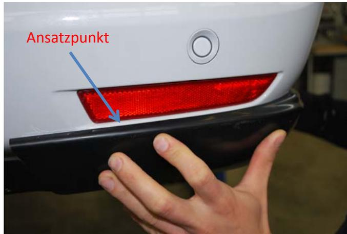
Beginnen Sie bei der Heckschürzenmontage zunächst mit den Heckecken. Richten Sie diese unmittelbar unter den Rückstrahlern und an der Karosseriekontur aus.
