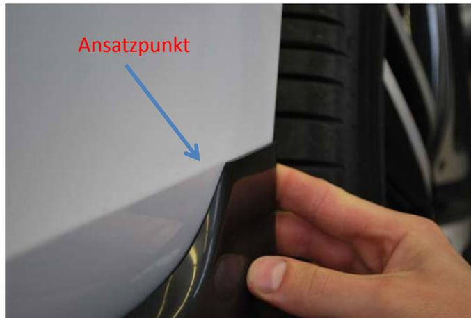
Das linke Bild zeigt eine V-Klasse. Richten Sie die Heckecke seitlich so aus, dass die Klebelasche an der Sichtkante der Heckschürze ansetzt. (Beim Vito liegt der Ansatzpunkt **ca. 10 mm** unterhalb der Sichtkante.)
