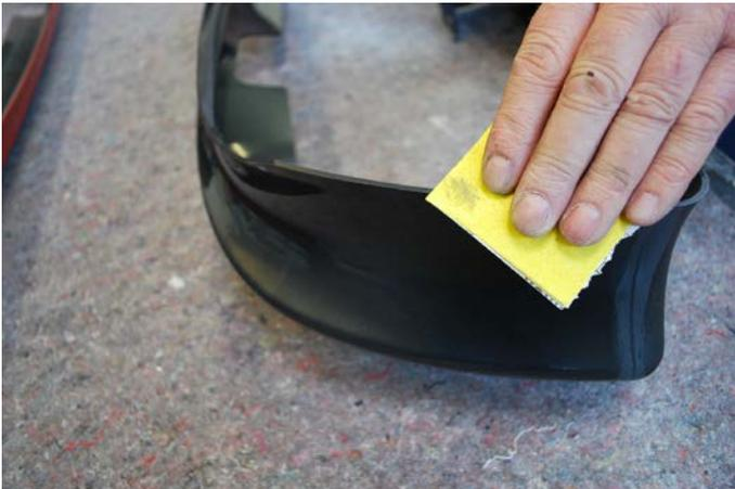
2. Arbeiten Sie die Fräskanten und Ecken vor dem Lackieren ggfs. mit Schmirgelpapier nach
