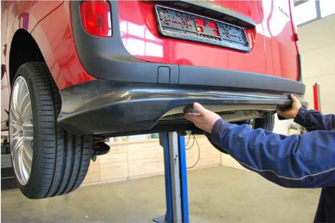
1. Setzen Sie die Heckspoilerlippe an das Fahrzeug an und überprüfen Sie die Passgenauigkeit.
