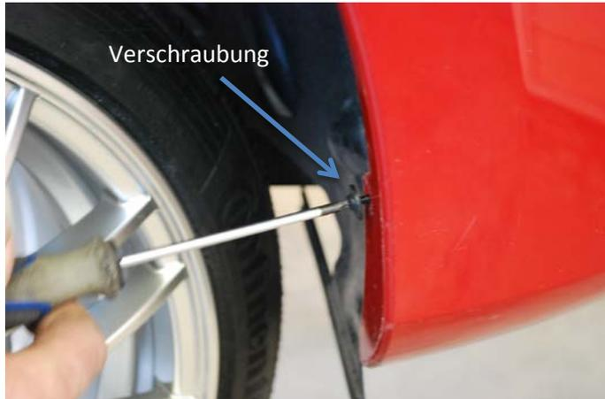
3. Entfernen Sie die unteren Verschraubungen der Innenkotflügel mit der Heckschürze.
