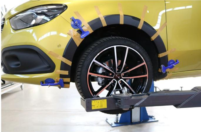
Das Bild zeigt den vorderen linken Kotflügel mit fixierten Anbauteilen. Im Bild in blauer Farbe sichtbar: Saugnapf-Fixierer (Saugnapf Klemmen)
