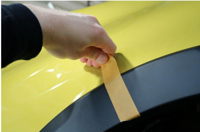
Fixieren Sie das Anbauteil anschließend mit geeignetem Klebeband am Fahrzeug.
