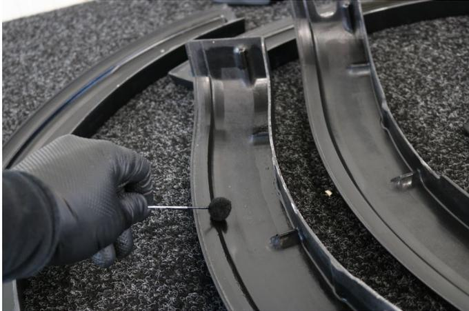
Anschließend primern Sie mit dem Marston-Domsel Primer die gereinigten Klebeflächen in den Anbauteilen.
