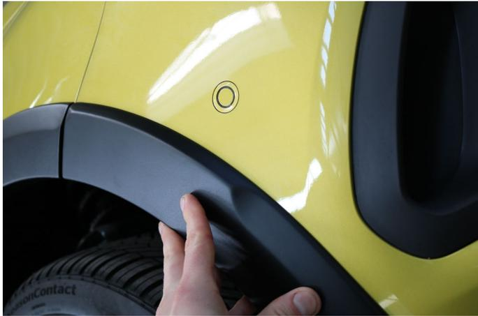
Setzen Sie Setzen Sie das Kotflügelaufsatzteil nun am Fahrzeug an und drücken Sie dieses fest an.
