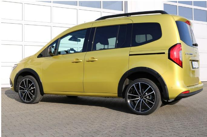
Das Bild zeigt den Citan mit fertig verklebten Kotflügelaufsätzen vorn und hinten.
