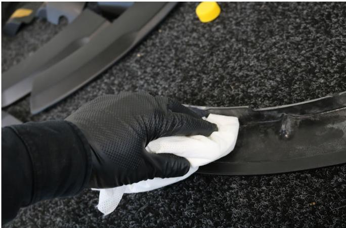
Reinigen Sie mit dem im Lieferumfang vorhandenen Marston-Domssel Reiniger nun gründlich die Klebeflächen in den Anbauteilen.
