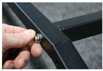
Detail 1: Edelstahlschraube M8x45 + Federring + Unterlegscheibe, eingeschraubt in den Querträger.
