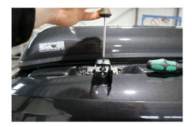
Drehen Sie Abstützschraube mit dem Kunststofffuß bis auf die Heckklappe hinunter, bis dieser "handfest" aufsetzt. Aber Achtung! Verformen Sie nicht das Metall!
