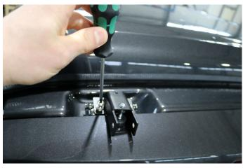
Verschrauben Sie im nächsten Arbeitsgang die beiden Halter für die Heckklappenscharniere mit den beiliegen den M8x25 Schrauben an den Heckklappenscharnieren mit einem **Anzugsmoment von 25 Nm**. Verwenden Sie pro Schraube einen Federringe und eine Unterlegscheibe Ø 8 mm.
