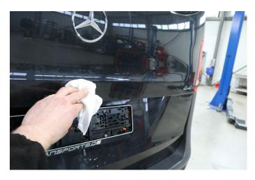
Reinigen Sie nun gründlich die Klebefläche der Abstützplatte. Verwenden Sie hierfür den im Lieferumfang enthaltenen Marston-Domsel Reiniger.
