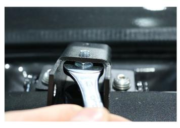
Drehen Sie anschließend die Kontermutter ebenfalls "handfest" nach oben an, sodass die Stützschraube kein Spiel mehr hat.
