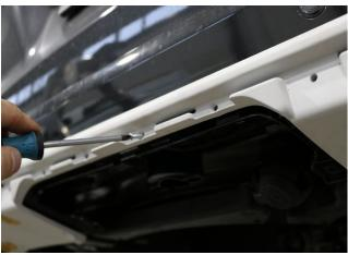
Verschrauben Sie das Heck-Mittelteil zunächst mittig, mit den Senkkopfschrauben 4,2x20 mm an der Heckschürze
