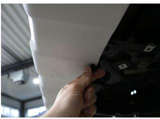
Setzen Sie die Diffusor-Mittelplatte in das verschraubte und verklebte Heck-Mittelteil ein und verschrauben Sie diese mit den 4 Rändelschrauben M4x10 mm.
