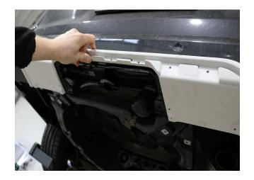
Setzen Sie die Heck-Mittelblende **vor der Lackierung** an das Fahrzeug an und prüfen Sie die korrekte Anbauposition.
