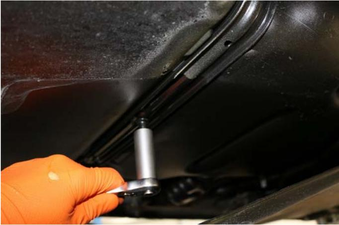
Ziehen Sie den Ansatzbolzen (Distanzschraube) mit einem Drehmoment von 10 Nm an.
