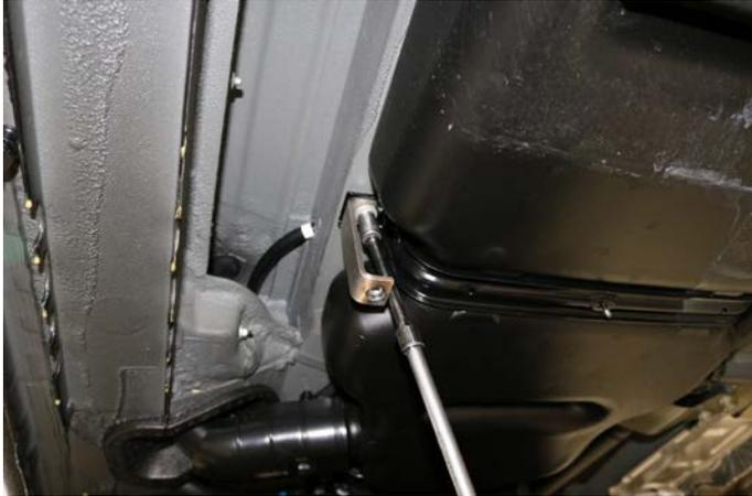
Auch hier wieder: Bitte nur **eine einzige** Tankhalteschraube lösen, den Halter ansetzen und die Schraubverbindung wieder herstellen.
