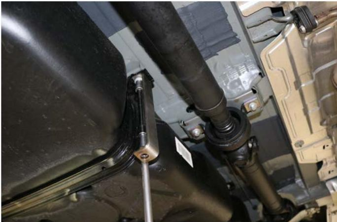
Setzen Sie den Halter für die Schutzplatte an dieser Schraubverbindung an, und verschrauben Sie nun Halter mit Tank-Haltekonsole.
