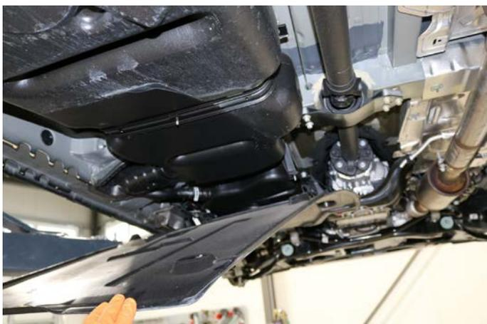
Sofern die Unterbodenplatte am Fahrzeug erhalten bleiben soll, Können Sie die beiden vorderen Schraubverbindungen belassen.
