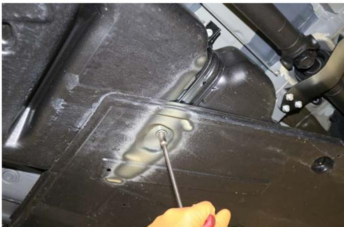
Lösen Sie zunächst die Schraubverbindungen der Original-Unterbodenplatte an der Tank-Haltekonsole.
