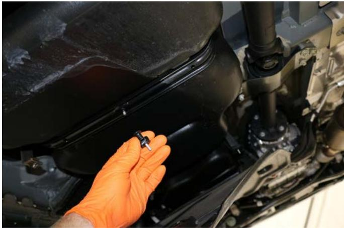
An der Tankkonsole befindet sich ein Stehbolzen (Verschraubung). Verlängern Sie diese Verschraubung mit dem mitgelieferten Ansatzbolzen (Distanzschraube).
