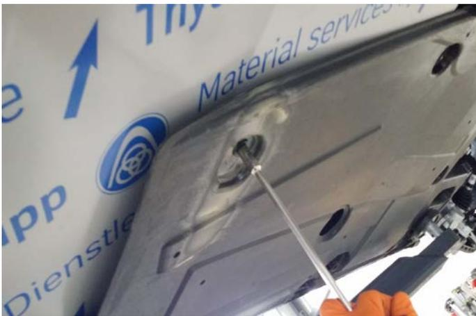
Verschrauben Sie zum Schluss die Original-Unterbodenabdeckung an den
