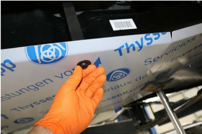
Verschrauben Sie die Unterfahr-Schutzplatte mit den Haltern.
